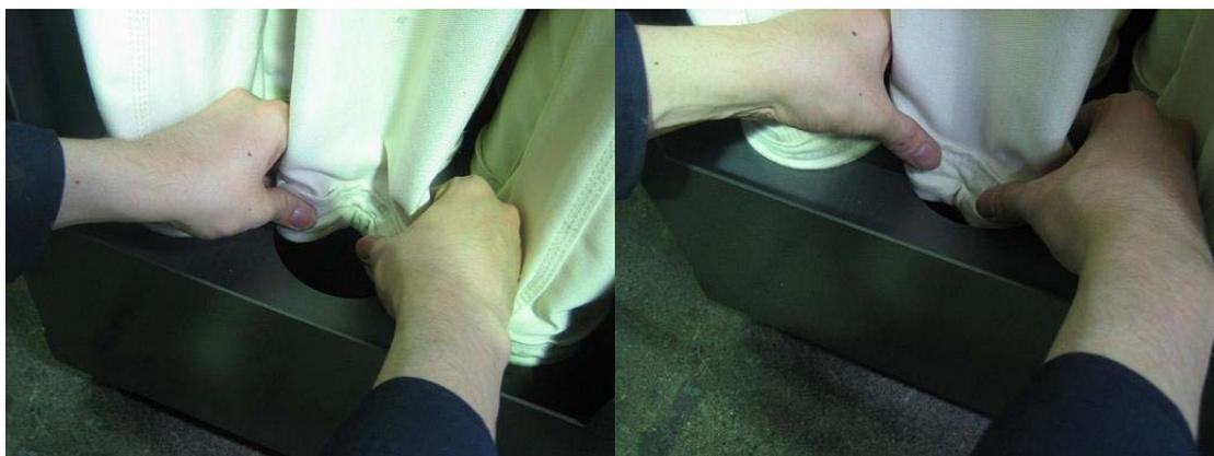
・フィルターがセットされたら、フィルター中央部を横に強く引っ張って、フィルターが外れないことを確認してください。フィルターが外れなければ正常にセットされています。
